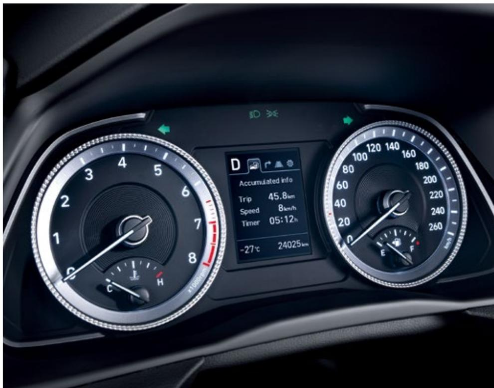
Panneau d'instrumentation LCD de 3,5 po
